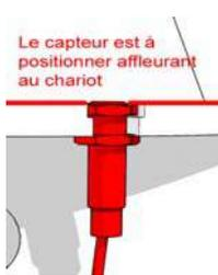
Le capteur est à positionner affleurant au chariot
