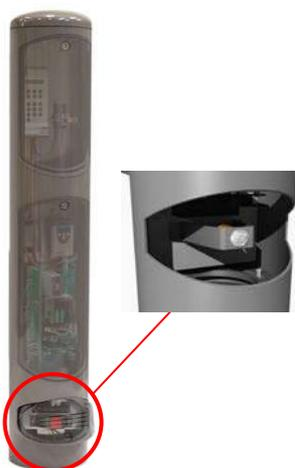
Située à la base du PGA, elle est accessible derrière une trappe montée sur charnière dont l'ouverture est verrouillée par une serrure à empreinte carré ou triangle. Les services d'urgence dispose ainsi d'un système d'accès normalisé, simple et rapide. Le pilotage des bornes (descente et montée) peut-être effectué par deux types de commandes :
