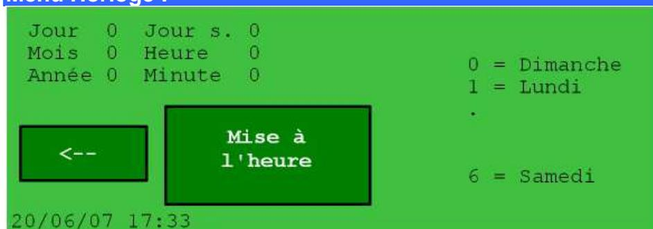
Ce menu permet de modifier manuellement la date et l'heure du site, par exemple pour tester l'accès livraison en dehors des heures de livraison.
