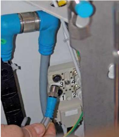
Connecter le capteur de rupture au répartiteur sur la prise 3.
