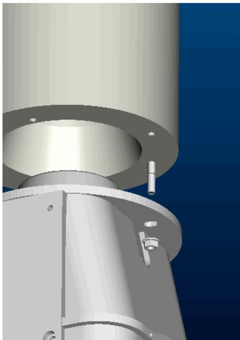
**3 kJ** : fixer la à l'aide des écrous M10 (clé plate de 17)
