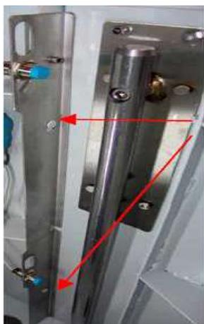
Enclencher le support des capteurs de position dans les ergots.
